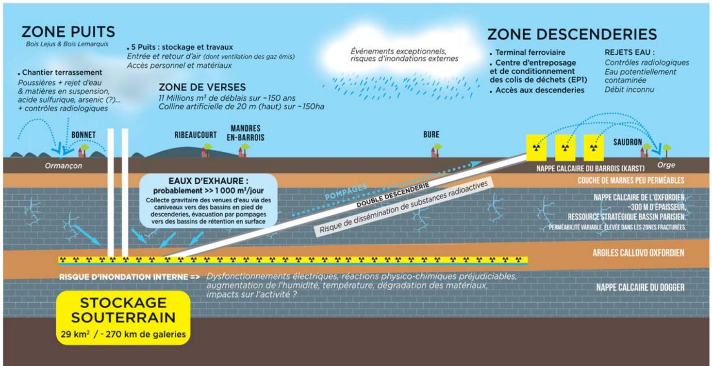
Cette représentation schématique (hors échelle) propose d'appréhender une partie de l'emprise et du fonctionnement de l'installation Cigéo
